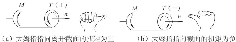
图 1-5-4 圆轴扭转时的正负规定
