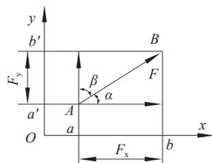
图 1-2-3 力  $F$  在直角坐标系上的投影
