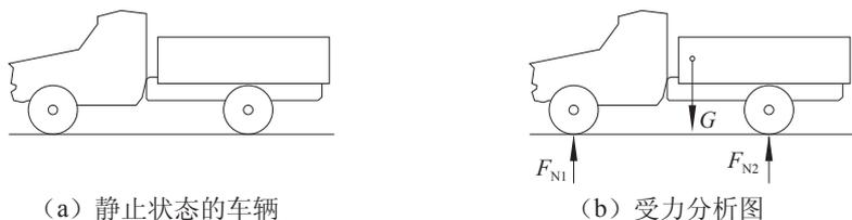
图 1-1-13 静止状态车辆的受力分析
