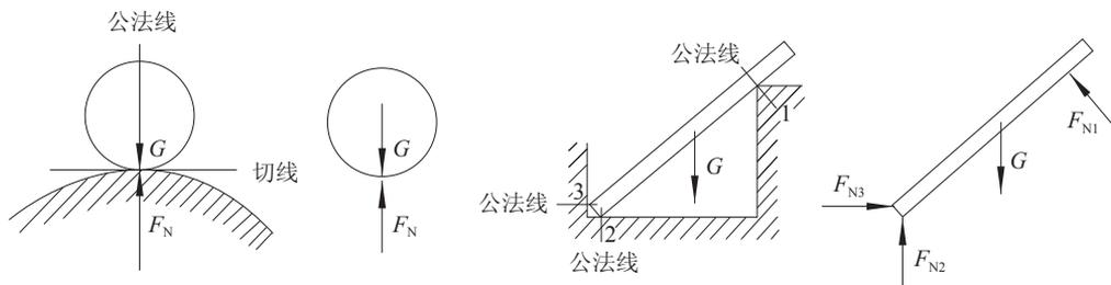
图 1-1-9 光滑面接触的约束及受力分析
