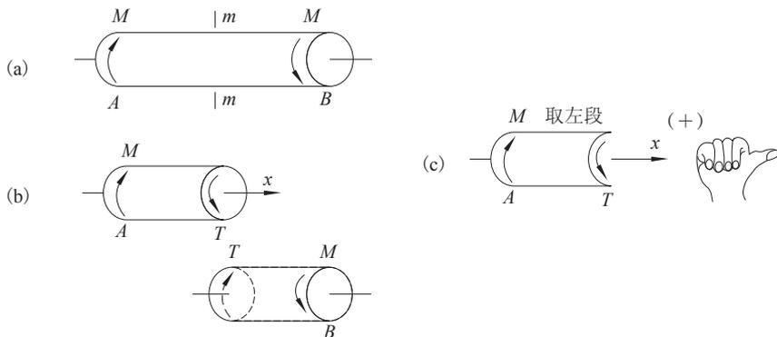
图 1-5-3 截面法求圆轴扭转时的内力
