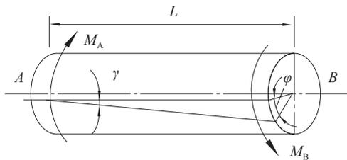
图 1-5-2 圆轴扭转的变形特点
