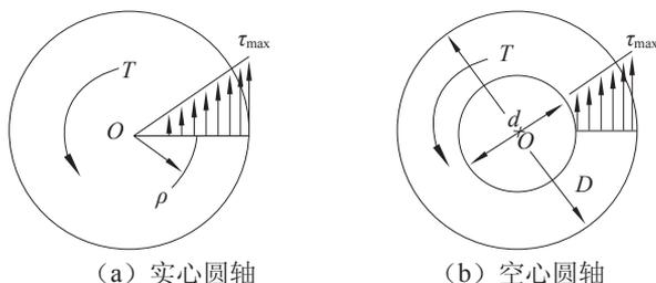
图 1-5-11 圆轴扭转时横截面上的切应力分布规律
