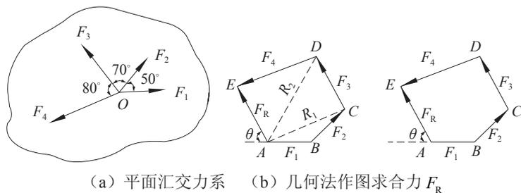
图 1-2-2 几何法求平面汇交力系的合力  $F_R$
