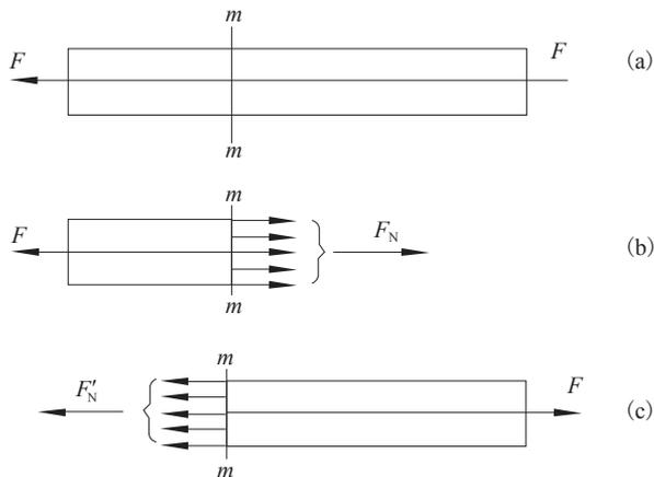
图 1-3-2 截面法求拉杆的内力
