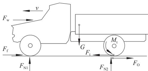
(4) 画出车辆受力分析图，如图1-1-14所示。 图 1-1-14 匀速直线运动状态车辆的受力分析
