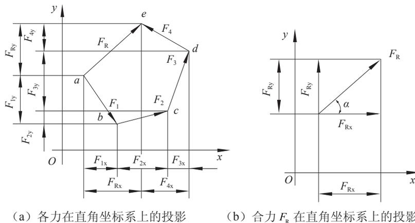
图 1-2-4 平面汇交力系在直角坐标系上的投影
