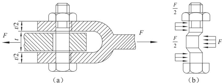
图 1-4-1 螺栓连接与受力、变形特点
