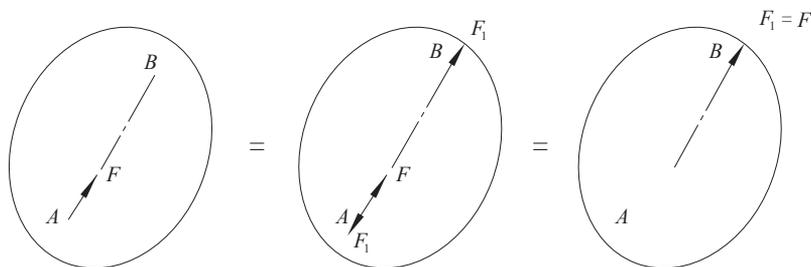
(a) 刚体上作用力  $F$  (b) 同时加上一对力  $F_1$  (c) 同时减去一对力  $F$  与  $F_1$
