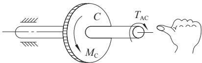
图 1-5-6 求  $AC$  段的  $T_{AC}$
