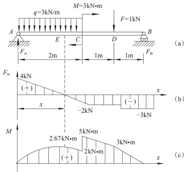
图 1-6-11 利用  $M$ ， $F_N$ ， $q$  之间的关系作剪力图、弯矩图
