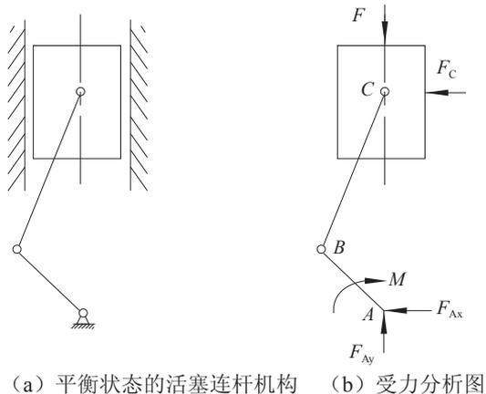
(a) 平衡状态的活塞连杆机构 (b) 受力分析图
