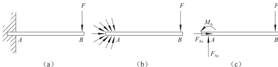
图 1-2-12 固定端约束力及简化
