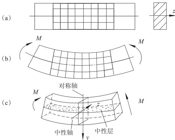
图 1-6-12 纯弯曲的变形
