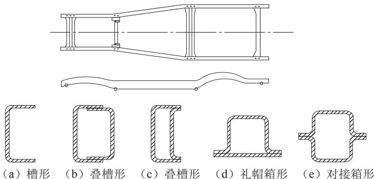
图 1-6-18 汽车车架纵梁的截面形状
