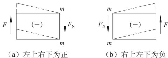
图 1-6-6 剪力  $F_N$  的正、负规定
