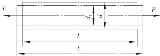
图 1-3-5 杆件受轴力作用产生纵向与横向变形
