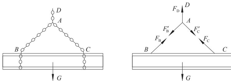
图 1-1-8 起吊重物及起吊重物时的受力分析
