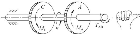
图 1-5-7 求  $AB$  段的  $T_{AB}$
