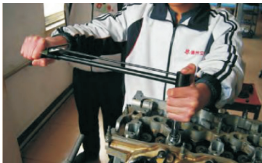
图 1-2-7 指针式扭力扳手及其使用方法
