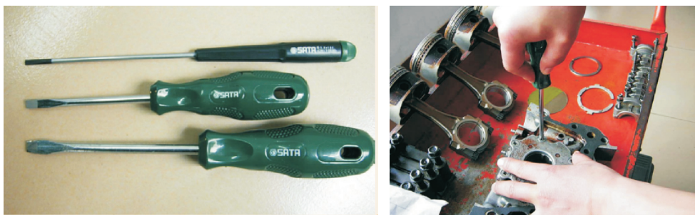
图 1-2-16 螺丝刀及其使用方法
