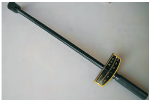
图 1-2-7 指针式扭力扳手及其使用方法
