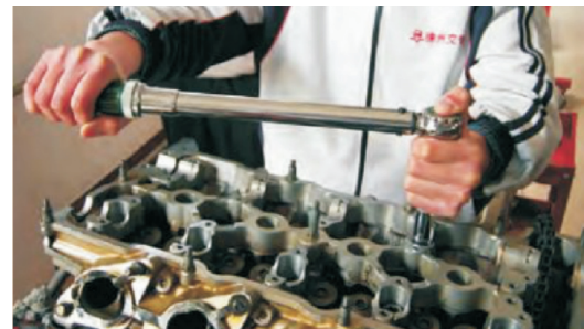
图 1-2-8 预置力式扭力扳手及其使用方法
