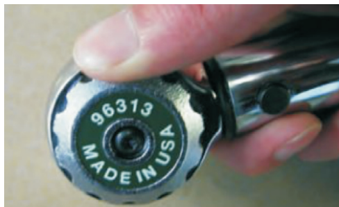
图 1-2-8 预置力式扭力扳手及其使用方法
